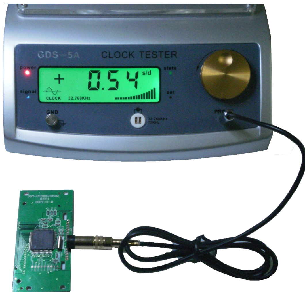
图 5. 时钟线路板测试
